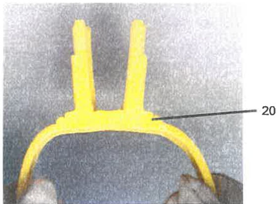
20. No gap or voids when bent
